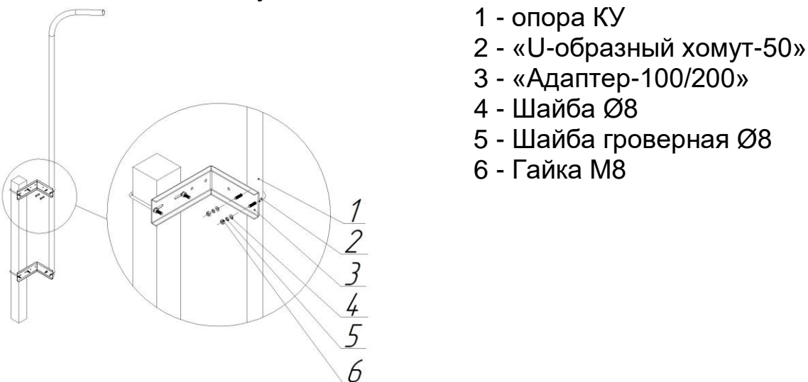
Рис. 6. Установка опоры КУ на адаптеры
