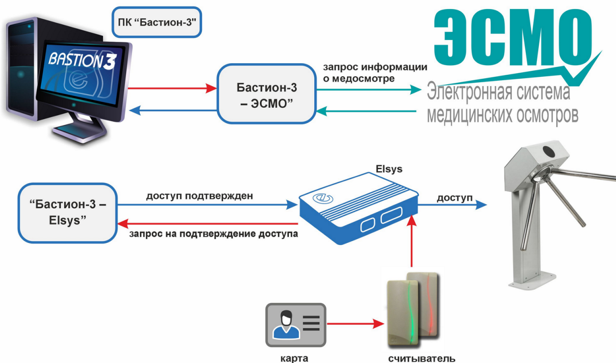
Рис. 1. Схема подтверждения доступа без алкотестирования
