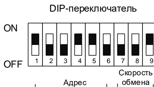
Рисунок 3. Установка сетевого адреса на DIP-переключателе.
